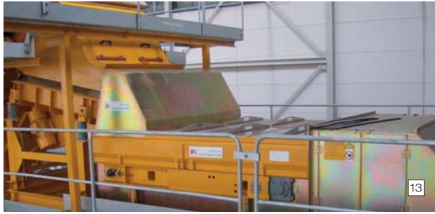
13 Wirbelstromscheider mit Rinnenbeschickung Eddy current separator with feeder 14 Hochintensitätsscheider 2-stufig 2-roll type high intensity separator
